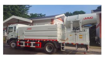
气中的灰尘、酸性物质的小颗粒带下来,达到净化空气的作用。日常使用的洒水车只能对地面的浮尘进行清理,空气中的降尘却一直都比较难处理。而这种喷雾式多功能抑尘车是通过将水转化为水雾的形式,直接对大
