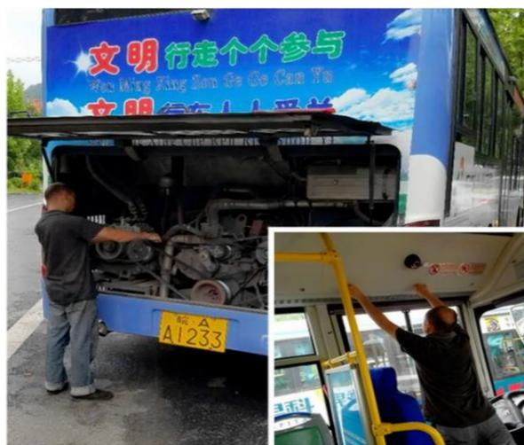
压机皮带部分进行了详细检查,安排排查出风口出风量大小,制定和督促定期清洁滤网,保障出风效果,同时就出现缺氟现象制冷效果不佳的车辆进行充装。
