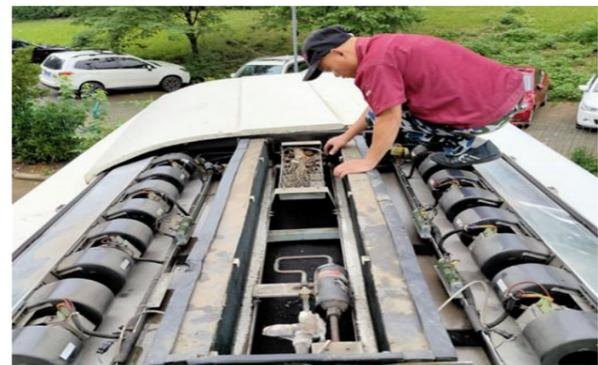
空调面板开关,查看面板运行状态显示是否完整正常,查看显示屏上角有无故障代码,查看空调风道及所有出风口,确认两边对应风口的风里大小一致。待空调运行15分钟后,再查看视液镜制冷剂是否正常。
